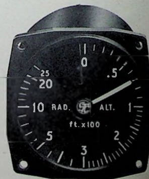
Afb. 4 en 5 De STR 5 radio hoogtemeter met indicator, één van de eerste typen voor autoland.
